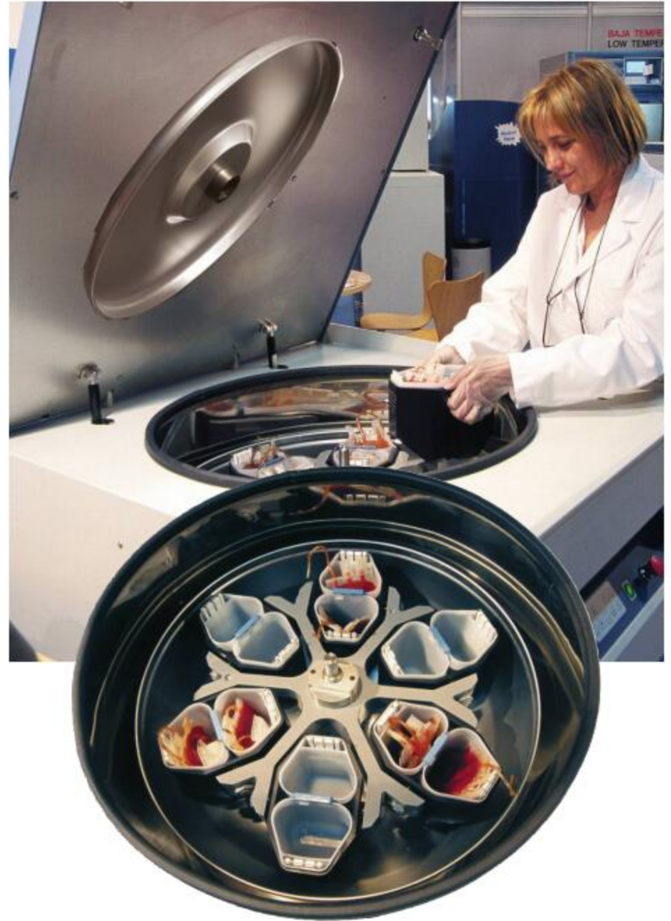
图示显示了旋转器和双向桶如何用于3, 4个500和800 ml的血袋
