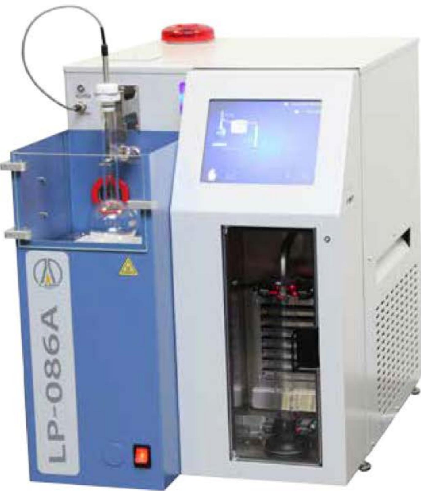
根据ASTM D 86、ISO EN 34052007、ASTM D 850、ASTM D 1078、DIN51751、IP 123、IP 191、IP 195和类似标准，全自动蒸馏装置LOIP LP086a 用于石油产品(0、1、2、3、4组)的常压蒸馏。
