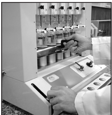
Colocación de los vasos al extractor.
