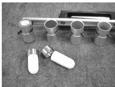
Colocación de los soportes de cartuchos.
