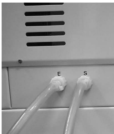
Fig 4.3: Conexiones de entrada y salida de agua refrigerante
