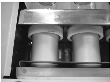
Colocación correcta de los vasos.
