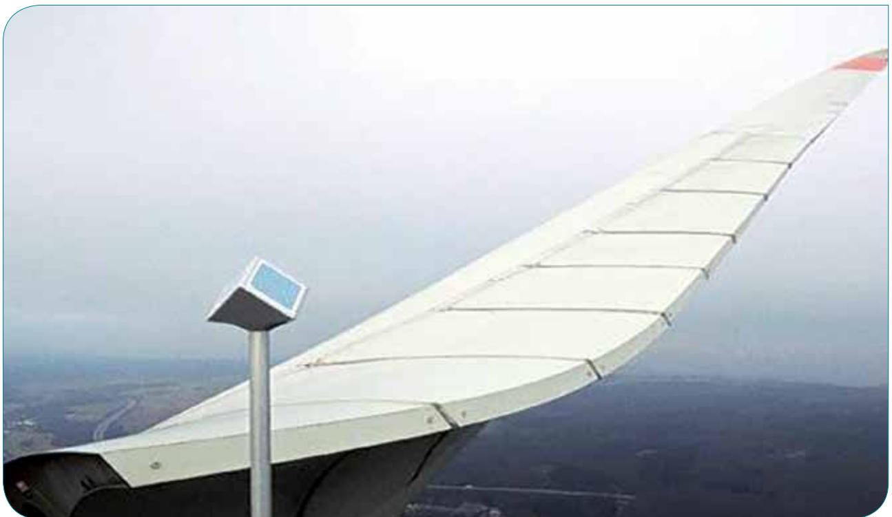
Pic: 安装在德国风力涡轮机上的 IDS-立方体传感器
