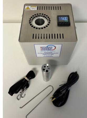
设备内置独立限位控制功能，可防止在超过460°C的工况或故障条件下运行。冷却风扇可在所有工作温度范围内保持内部元件和控制器的恒温状态，从而实现更高的精度和稳定性。
